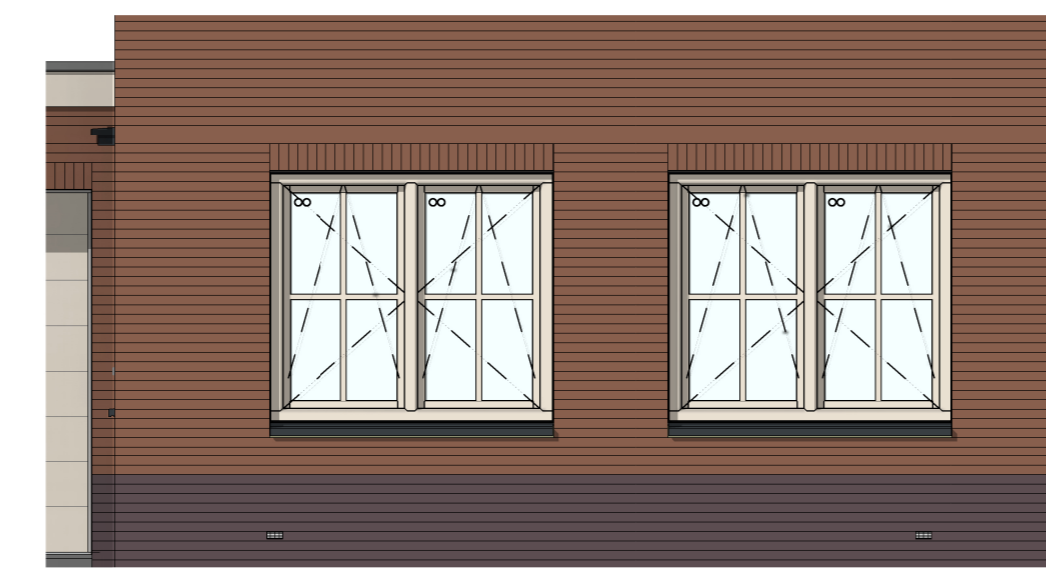
VG5009 - Gevelkozijn met hoge borstwering
